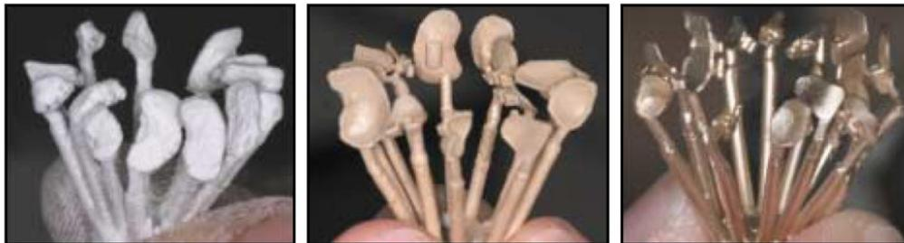
**Gambar 2.24** Hasil *Casting dan Finishing* <sup>22</sup>
