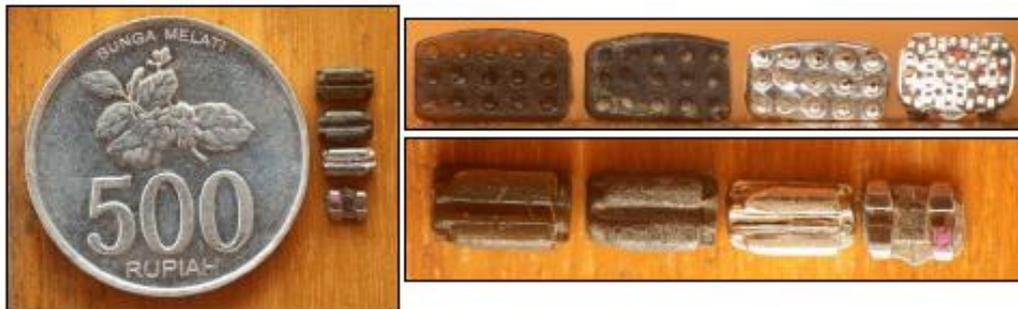
**Gambar 4.18** Perbandingan dari Kiri-Kanan: *Wax Pattern*, Braket sebelum *Electropolishing*, Braket sudah *Electropolishing*, dan Braket Impor<sup>20</sup>
