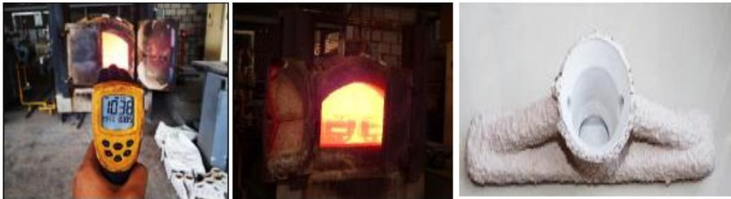
**Gambar 4.13** Proses *Dewaxing* dan Cetakan *Ceramic*<sup>20</sup>
