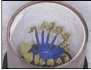
**Gambar 2.23** *Sprue dan Runner di dalam Tube* <sup>22</sup>
