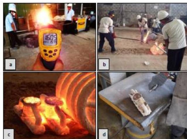
**Gambar 4.14** Proses *Casting*: a. Proses Pelelehan *Stainless Steel*, b. Proses Pengecoran, c. Proses Solidifikasi, d. Proses Pendinginan<sup>20</sup>
